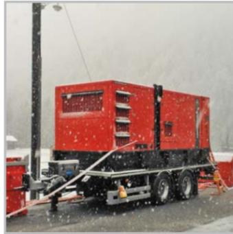
**RESISTENCIA A LA INTEMPERIE.** Preparados para hacer frente a la lluvia, hielo, nieve y altas temperaturas. Resultados que se han obtenido sin sacrificar la prestación acústica ni la capacidad de ventilación y refrigeración del motor la cual está garantizada hasta 55°C (derating apli
