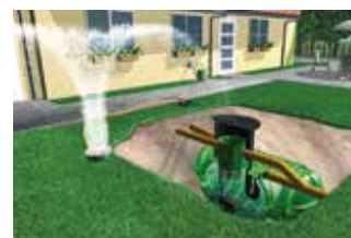
Roth Rain 3500 PLUS para riego de jardines Compuesto de ROTHAGUA® Twinbloc® 3500, filtro horizontal, grupo de presión sumergido, kit aspiración, accesorio antirremolino y equipo automático de entrada de aguas de red.
