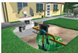
Roth Rain 5000 ECO para pequeños consumos Compuesto de depósito ROTHAGUA® Twinbloc® 5000, filtro cesta para aguas pluviales, grupo de presión sumergido, kit aspiración y accesorio antirremolino.
