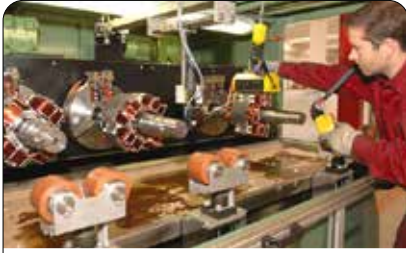
La impregnación "DIP and ROLL" garantiza alta resistencia a las vibraciones torsionales
