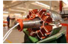
El bobinado compacto neutraliza la acción de la fuerza centrífuga
