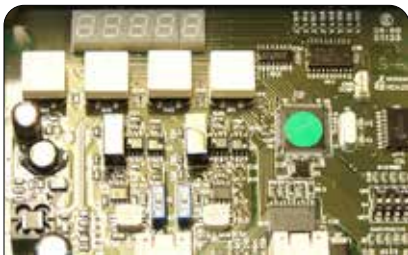
Tarjetas electrónicas desarrolladas con potente micro controlador y tecnología smd, ensambladas de forma automática
