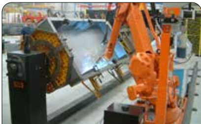
Técnica de soldadura MIG/MAG para conseguir acabados precisos y cordones de soldadura herméticos
