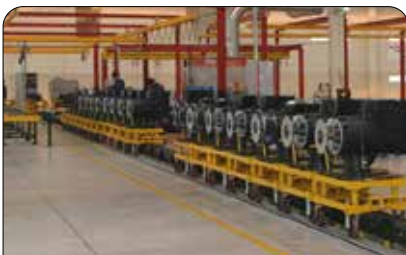
Ensayo de rutina a plena carga y sobrevelocidad a la totalidad de los alternadores
